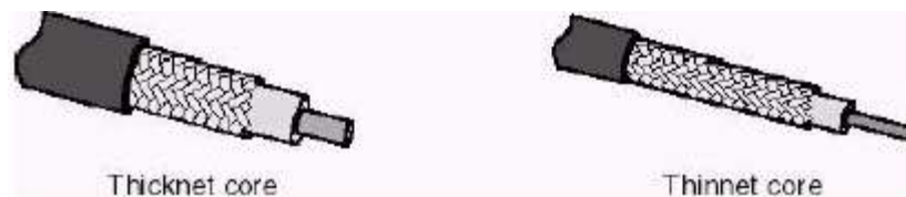
Gambar 7. Kabel Coaxial Thicnet dan Thinnet
